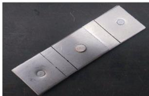
b 拉剪试样接头形貌
