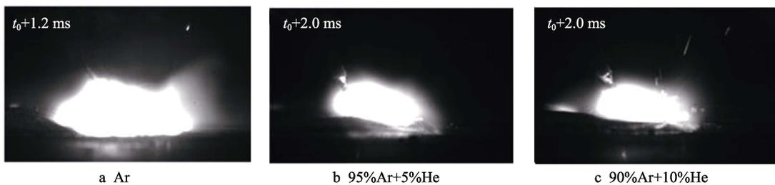
图 12 不同成分保护气体下电弧高速摄像图
