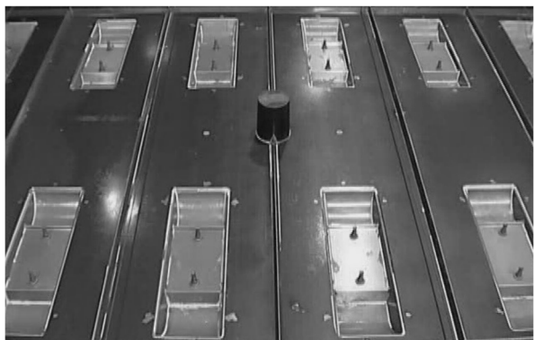
图1 高速铁路承轨台模板
