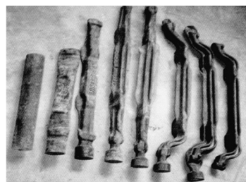
图10 精密辊锻-精密热模锻各道工序的锻件
