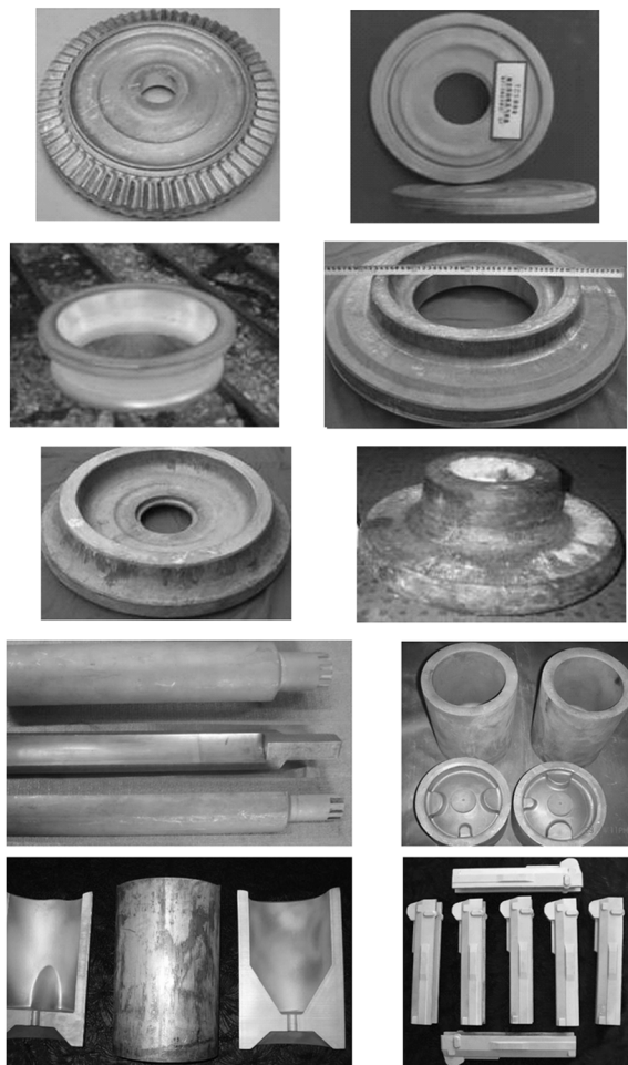
图14 等温锻造成形的航空、兵器用高强度锻件
