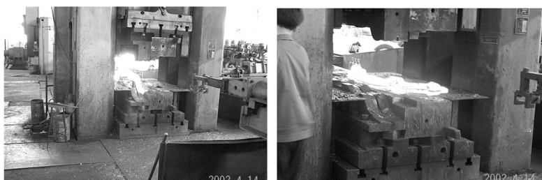
图9 25MN( 2500 t) 螺旋压力机的锻造成形流程
