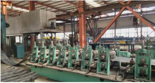
图5 辊弯工艺生产线
