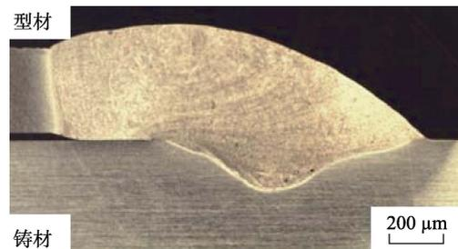
图2 MIG焊接接头截面
