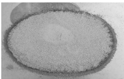
图 6 用于制备吸液芯的铝粉烧结试验
