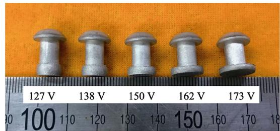
b 144 000  $\mu\text{F}$  自激励式电磁铆接下成形铆钉
