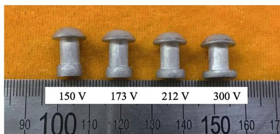
e 放电能量 2160 J 下感应式电磁铆接成形铆钉
