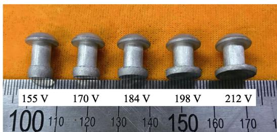
c 96 000  $\mu\text{F}$  下自激励式电磁铆接成形铆钉
