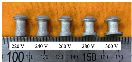
d 48 000  $\mu\text{F}$  自激励式电磁铆接下成形铆钉
