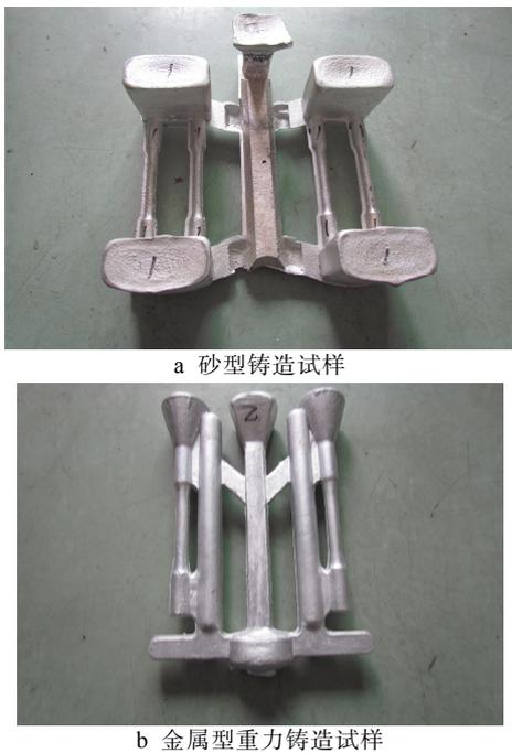
图2 两种铸造试样
