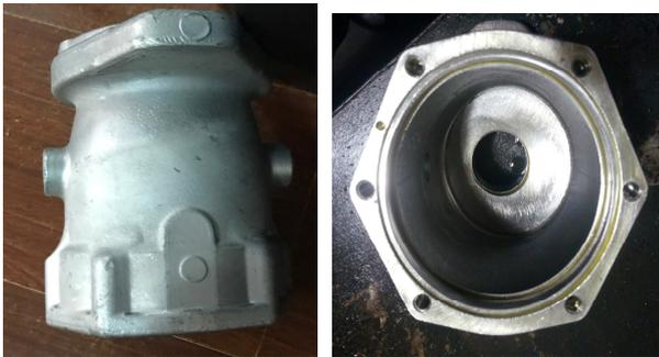
图 6 金属型铸造油马达铸件及加工后效果
