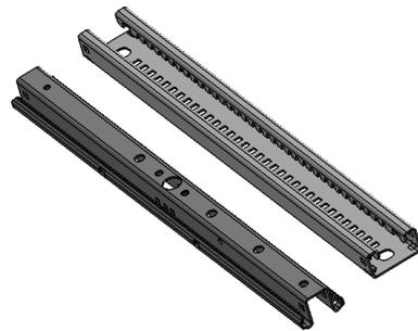
图7 座椅滑轨零件数据模型
