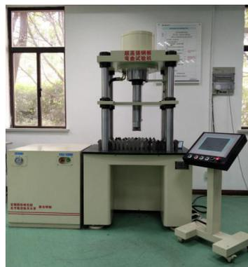
图3 压弯试验机
