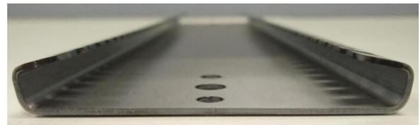
图8 完成二序折弯成形的滑轨零件
