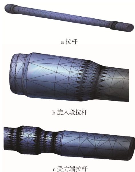
图2 拉杆过渡圆角的网格细化处理 Fig.2 Mesh refinement of fillet transition
