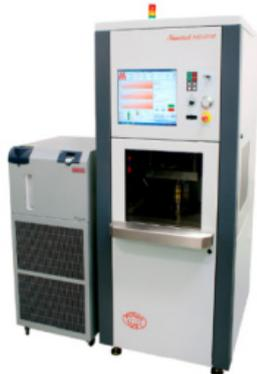
图 2 穆尔公司的 140GPM 玻璃模压成形机
