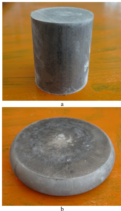
图3 9S71 高强铝合金棒材的超塑性变形
