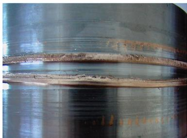
图5 剪切试样照片
