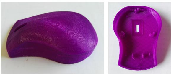
图2 新型鼠标底座3D打印制品
