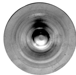
图5 8道次拉深后实验结果
