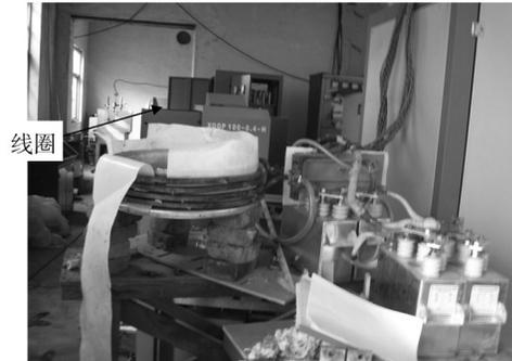
图3 毛坯感应加热
