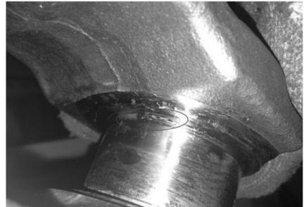
图10 曲轴疲劳实验轴颈圆角处断裂
