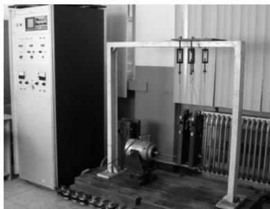
图3 电动谐振式曲轴疲劳实验机
