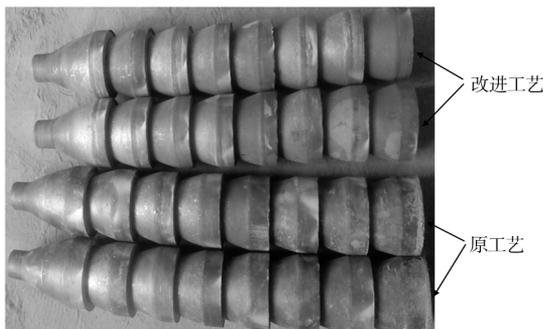
图6 采用定量精确成形技术和原工艺生产的挤铸毛坯对比
