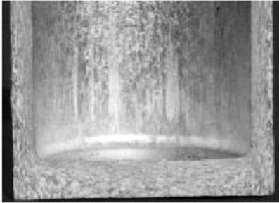
图2 用铸料冲制的罐底金属内部组织结构
