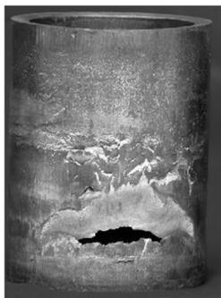
a 罐体冲制毛坯裂口现象的典型标本
