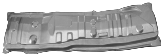
图 6 冲压完成后的工件
