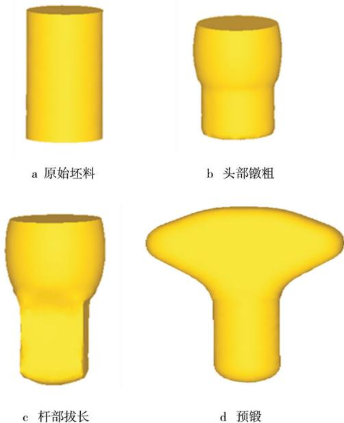
图 5 制坯工艺模拟成形
