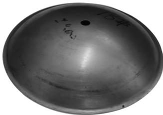
图9 成品隔片零件
