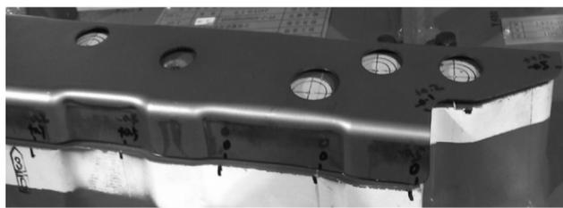
图7 回弹补偿后冲压件在检具上的状态
