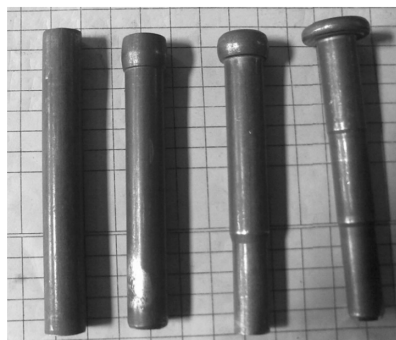
图 1 某螺栓冷镦加工过程
