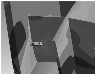
图 19 改进后机架上部筋板等效应力
