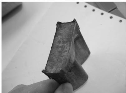
图5 第1块坯料的角部反挤现象
