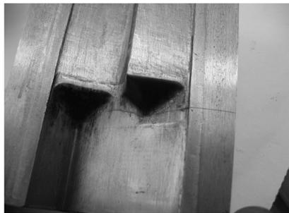
图4 凹模的横向裂纹
