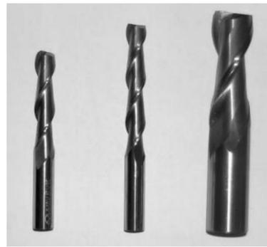
图5 硬质合金两刃键槽铣刀
